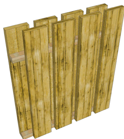
Un double bardage en décalé est très efficace pour réduire la vitesse du vent
